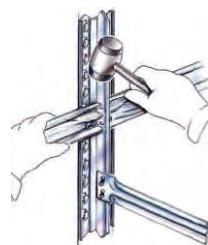
В случае необходимости, можно увеличить длину стеллажа: модуль наращивается посредством установки дополнительной секции.
